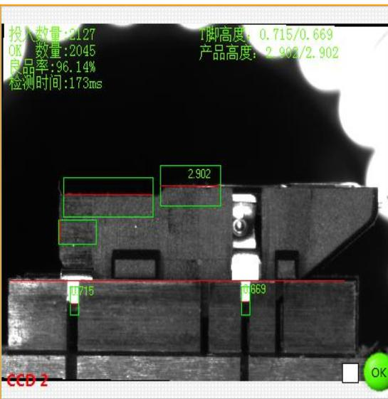
图14 T脚高度检测
